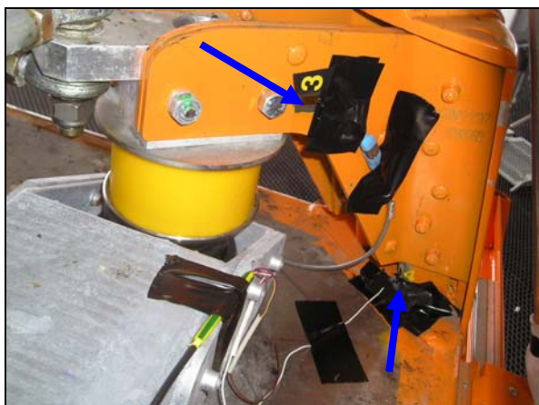
Figura 5 ER su elementi della cabina
