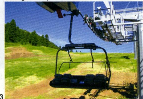
1. Punti estensimetrici su seggiola 2. Misure estensimetriche in laboratorio 3. Veicolo a pieno carico
